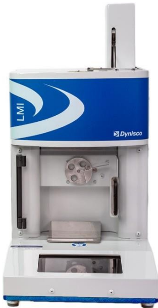
LMFI s digitálním enkodérem a systémem automatického odřezu
